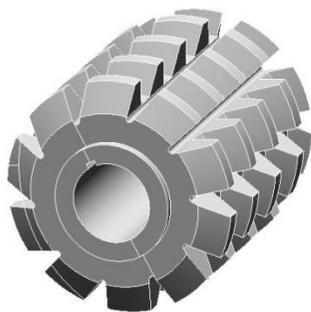
Червячные фрезы для нарезания цилиндрических зубчатых колес применяются для черного, получистового и чистового нарезания прямозубых и косозубых колес модулей 0,1...40 мм [32]. Согласно ГОСТ 9324-80 Е, в зависимости от назначения и размеров червячные фрезы изготавливаются классов точности
