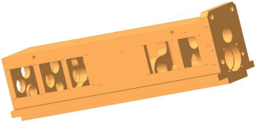
Рис. 1.17. 3D-модель корпуса шпиндельной бабки станка СФ68ВФ4
