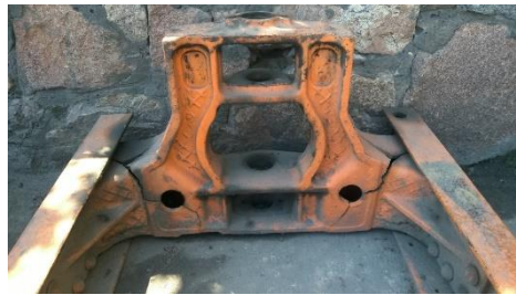
Рис. 1. Руйнування опори вертикального шарніру
