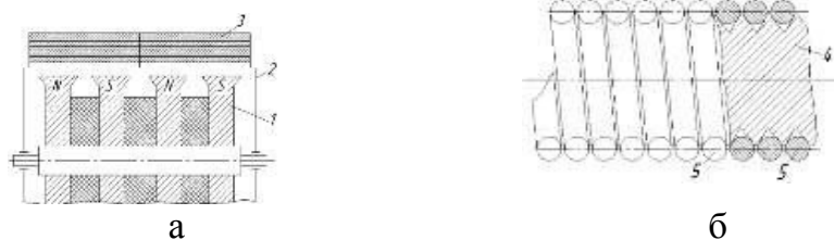
Рис. 1 - Полиградиентный магнитный сепаратор: а – продольный разрез сепаратора; б – элементы полиградиентной среды
