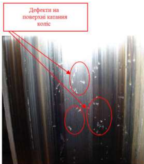
Рис. 1. Дефекти на поверхні катання коліс
