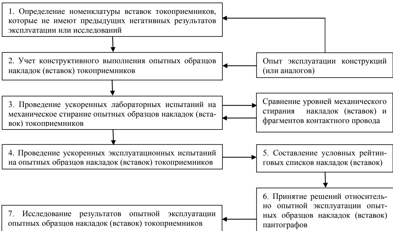
Рис. 1. Методика сравнительной оценки качества накладок токоприемников
