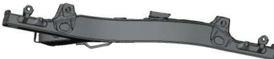
Рис. 8. Форма коливань, яка відповідає частоті 12,4 Гц
