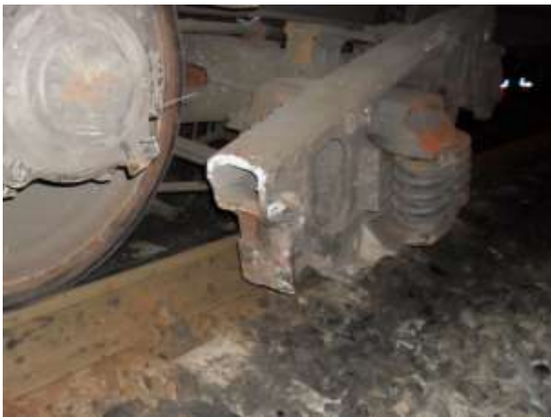
Рис. 1. Типове руйнування бічної рами візка типу 18-100
