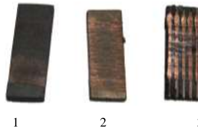
Рис. 2. Фрагменты накладок после проведения испытаний (приведена их нумерация в соответствии с данными таблицы 2)
