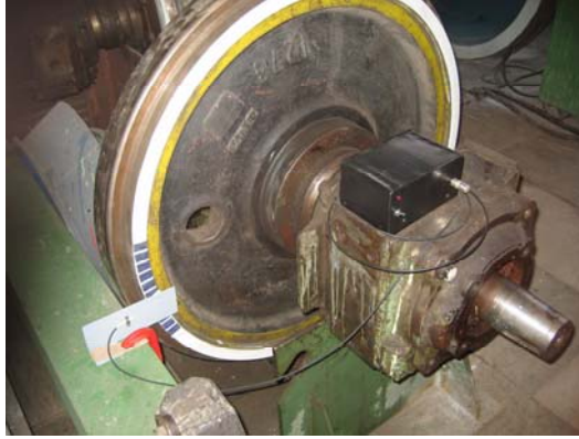
Рис. 2. Експериментальна установка для дослідження процесу контролю тріщиноутворення коліс
