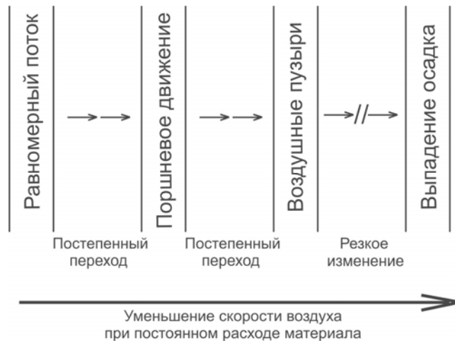
Рис.1. Изменение структуры восходящего потока при постепенном уменьшении скорости несущей среды
