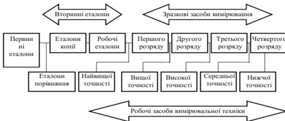
Рисунок 3.1 – Узагальнена схема передачі розмірів одиниць фізичних величин
