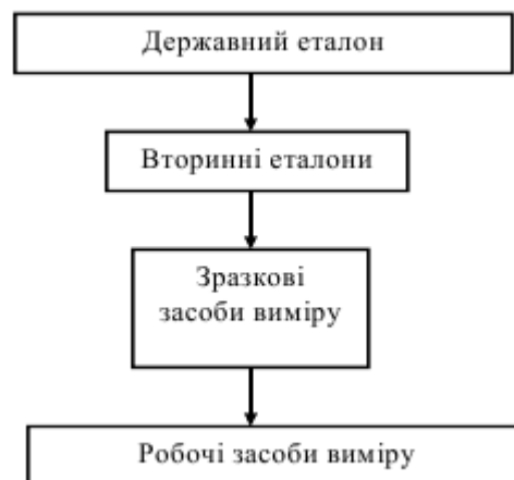
Рисунок 1.1 - Схема державної перевірочної системи одиниць вимірювань
