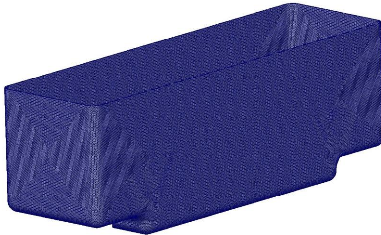
Рисунок 3.30 – Скінчено-елементна модель запропонованого концепту композитного модуля кузова вагона-вуглевоза
