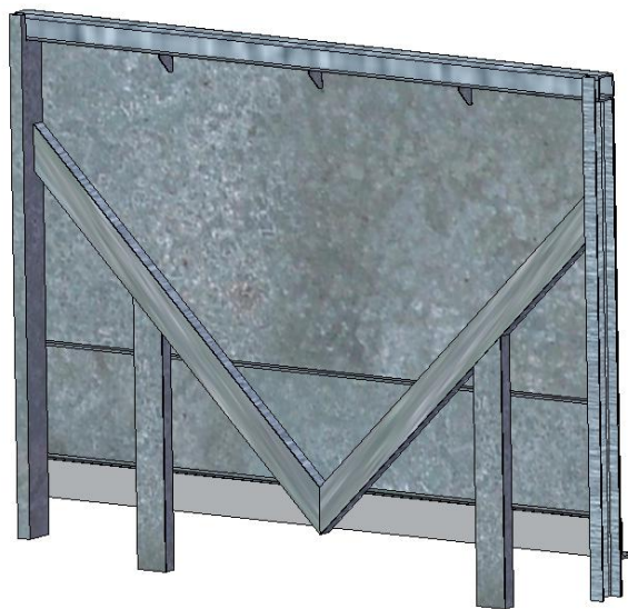
Рисунок 1.12 – Стіна торцева вантажного вагону моделі 12-4745. Перспективна конструктивна схема
