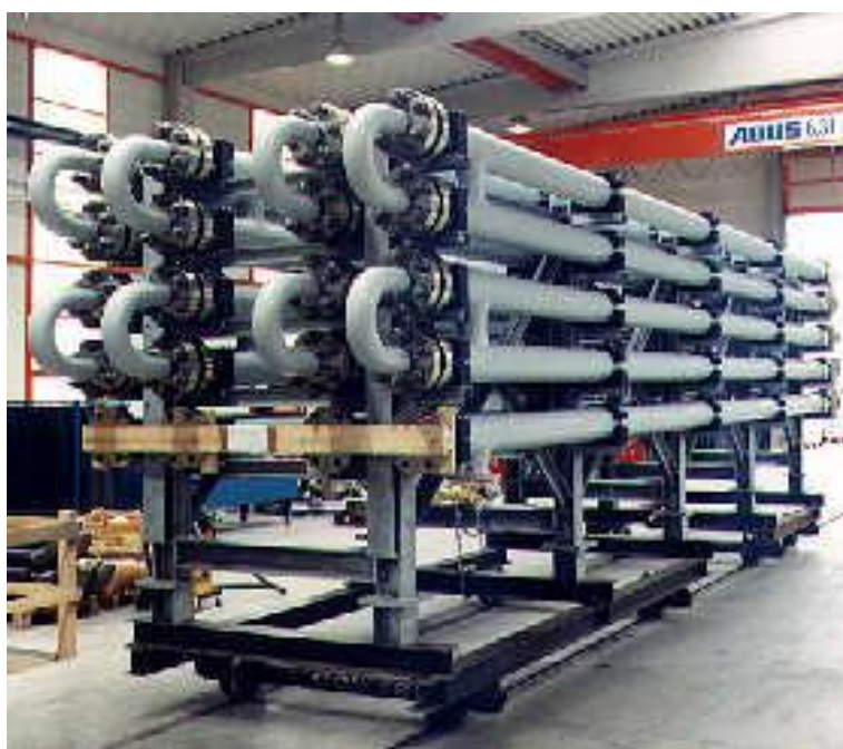
Рисунок 4.4 – Реактор трубчатого типа перед нанесенням ізоляції
