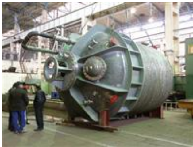
Рисунок 4.1 – Апарат ємнісного типу перед монтажем
