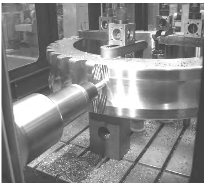
Рис. 4. Нарезка зубьев торцовой фрезой на станке с ЧПУ «TOS VARNSDORF»
