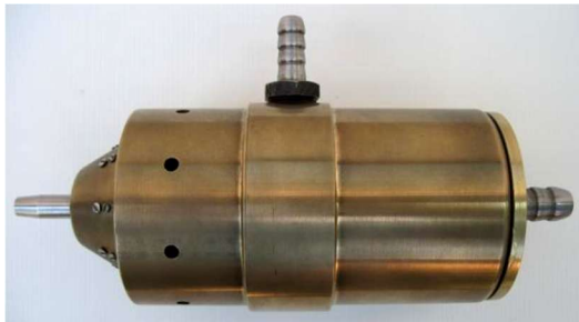
Рис. 4.1. Експериментальний зразок пневмошпинделя
