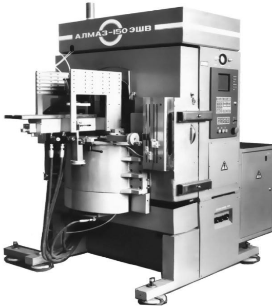
Рис. 1.14. Верстат автоматичного прецизійного різання «Алмаз – 150 ЕШВ»
