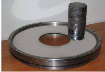
Рис. 1.16. Натяжний пристрій верстата з АКВР і монокристал кремнію
