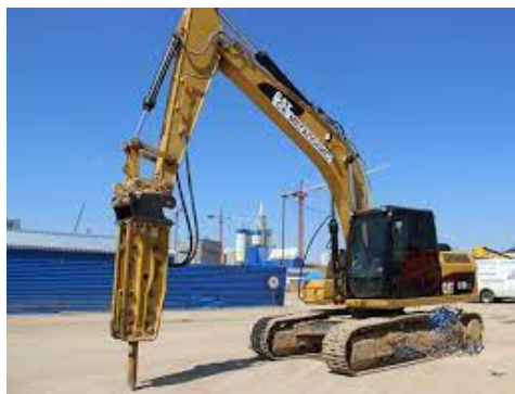
Рис. 3.17. Гідравлічний молот на базі екскаватора
