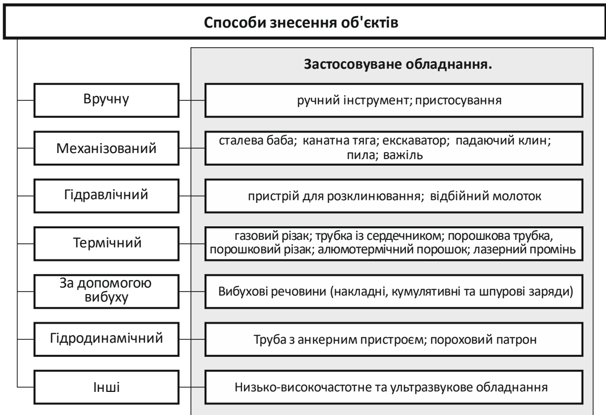
Рис. 3.5. Способи знесення об'єктів та обладнання, що застосовується
