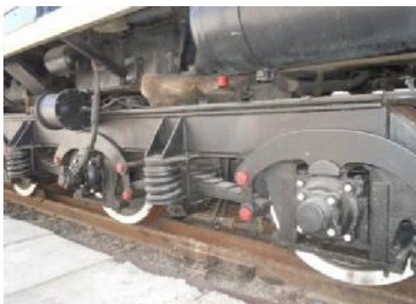
Рис. 6. Буксовые струнки тепловоза ТЭМ2
