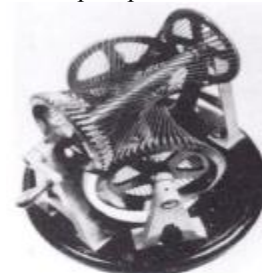
Рис. 1. Гиперболоидная зубчатая передача
