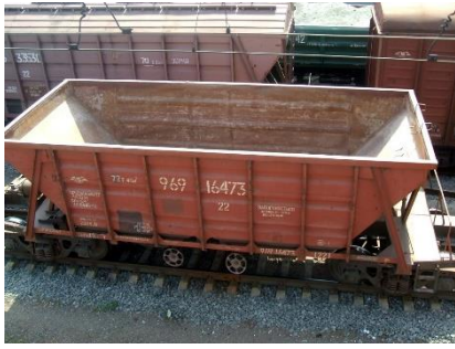
Рис. 2. Вагон-хopper для цемента с снятой крышей модели 19-758-01
