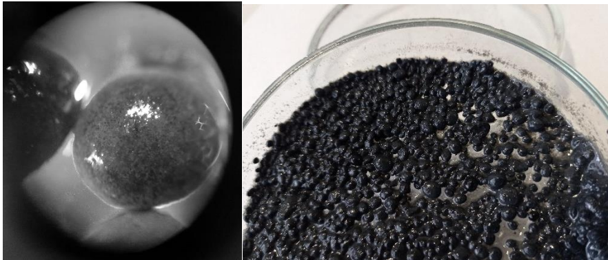
Рис. 2. Гранульований активний мул: ліворуч гранула активного мулу при мікроскопіюванні (збільшення 10×4); праворуч – загальний вигляд гранульованого мулу
