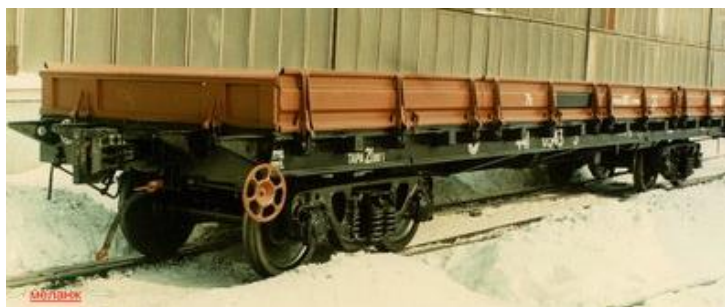
Рис. 1. Универсальная вагон платформа модели 13-4012
