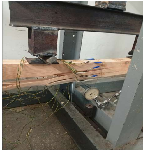
Рис. 1. Характерне руйнування соснової балки
