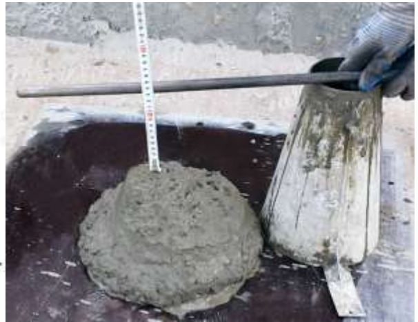
Рис. 9.1. Визначення рухливості бетонних сумішей за осадкою конуса (ОК): 1 – опори; 2 – ручки; 3 – форма-конус; 4 – бетонна суміш
