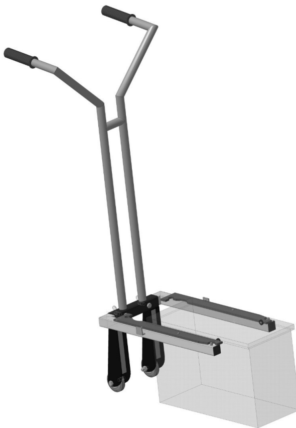
Рисунок 1 – 3D модель візка для транспортування акумуляторних батарей
