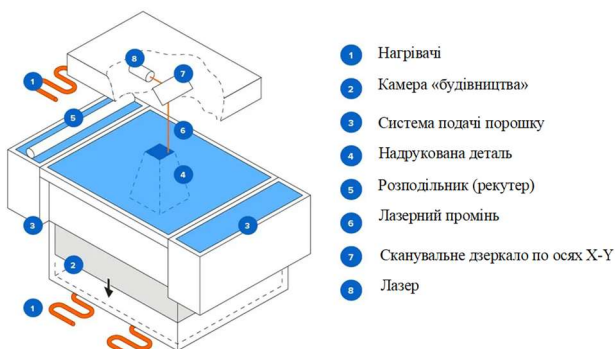
Рис. 3. Схема моделювання деталей друкарського обладнання методом «SLS» [13]
