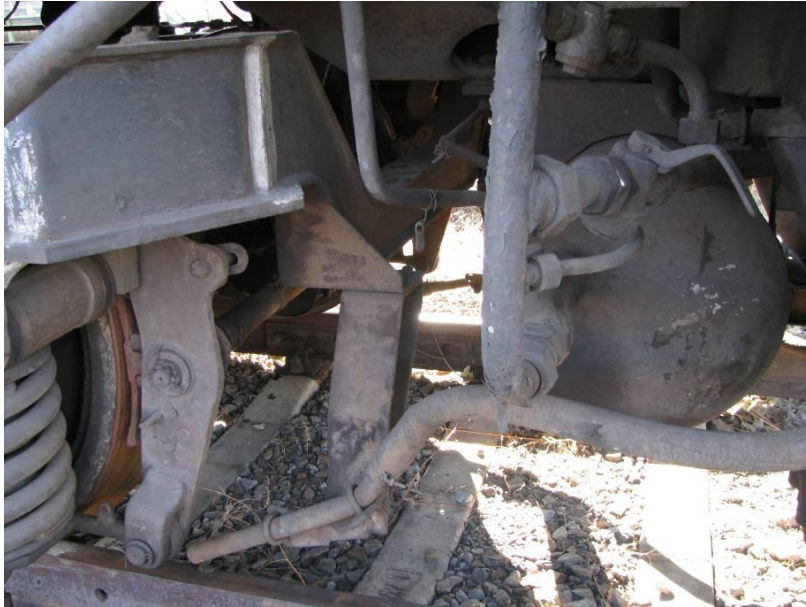
Рисунок 1 – Кріплення пісного трубопроводу з наконечником кронштейном на рамі візка
