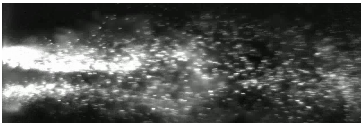
Рисунок 1 – Зображення запиленого потоку газу, отримане високошвидкісною цифровою камерою на основі ПЗЗ-матриці
