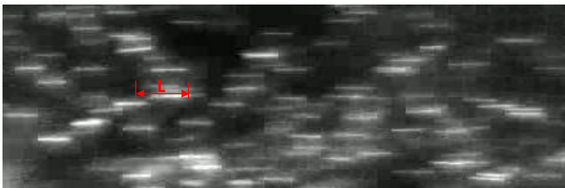
Рисунок 2 – Зображення треків частинок при часі експозиції \tau=10 мкс
