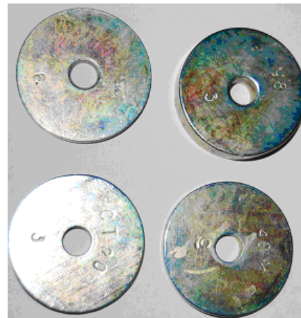
Рис. 2. Общий вид образцов, покрытых цинком
