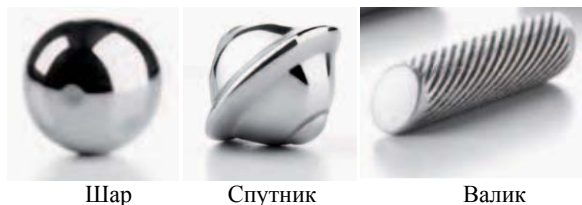
Рис. 5. Пример гранул, используемых для полировки деталей ВиО
