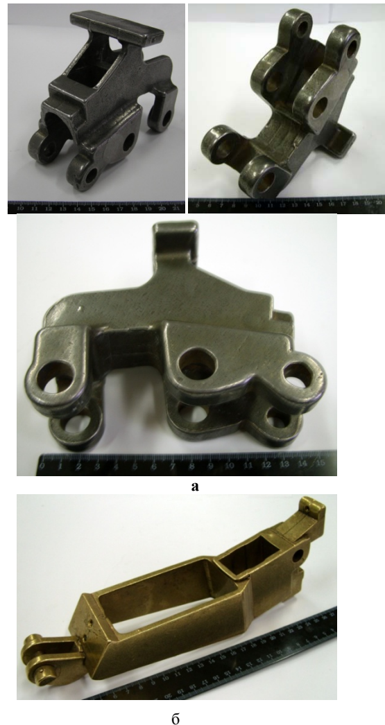
Рис. 7. Внешний вид исследуемых деталей после ВиО: а – рычаг; б – кронштейн
