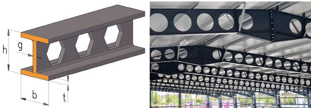
Рис. 9.19. Балки з перфорованою (отвірчастою) стінкою
