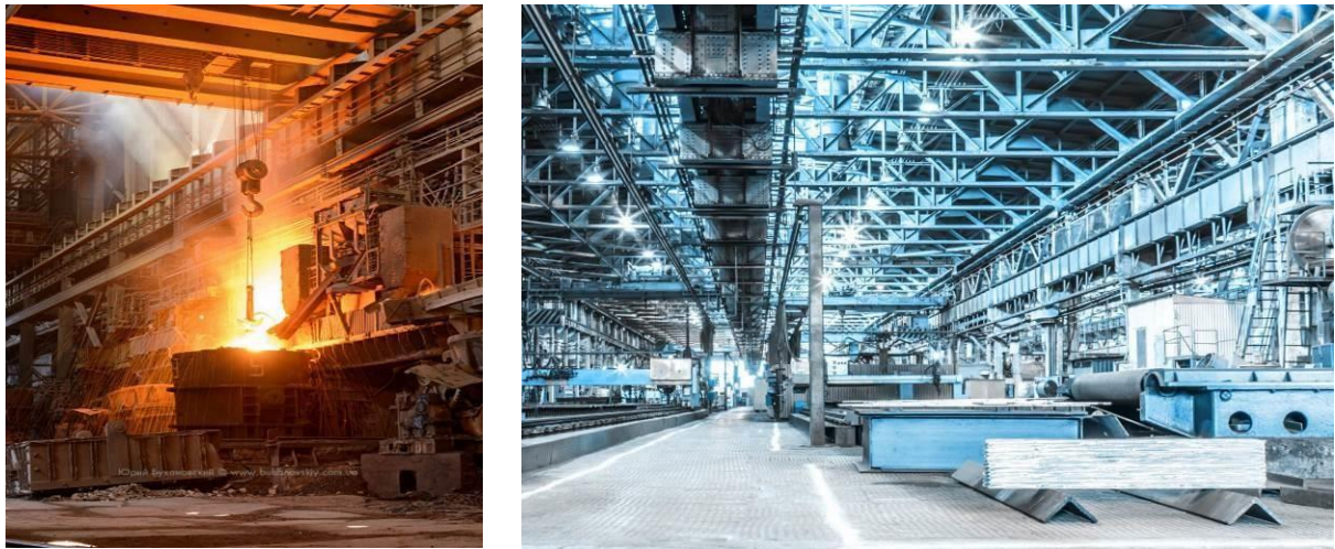
а б Рис. 11.1. Умови експлуатації кроквяних ферм: а – сталеплавильний цех; б – механоскладальний цех
