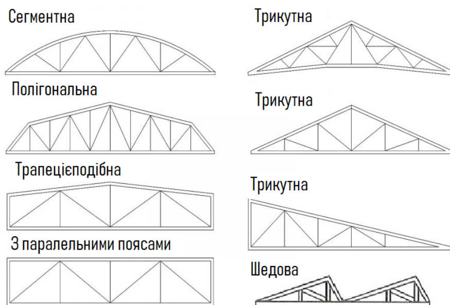
Рис. 11.4. Схеми обрисів поясів ферм
