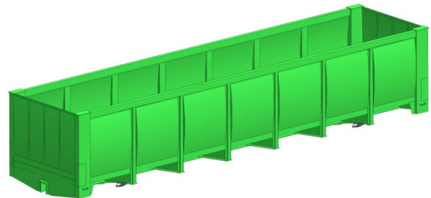
Рис. 1. Несуча конструкція напіввагона з випуклими стінами
