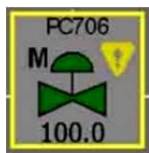
Рис. 1.4. Вікно регулюючого клапана
