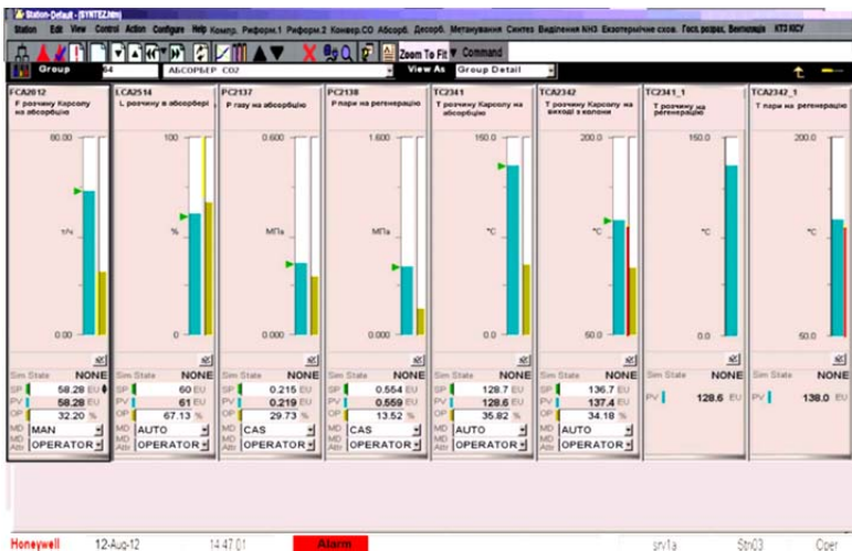
Рис. 1.28. Мнемосхема групи контурів регулювання
