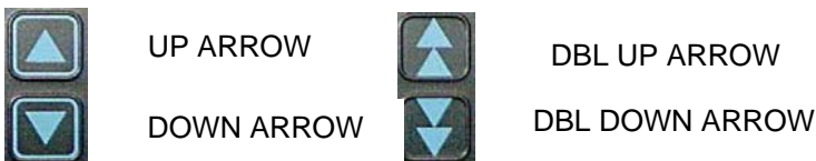
Рис. 1.15. Кнопки швидкої дії для зміни цифрових значень регулятора
