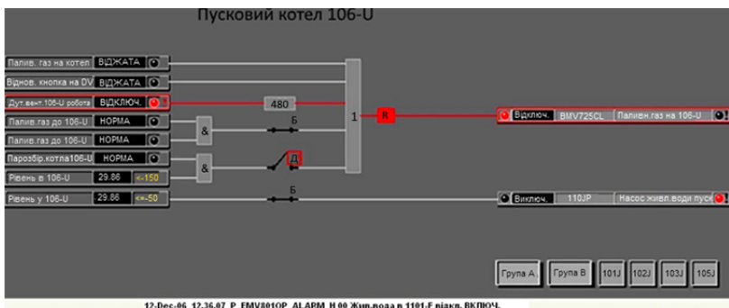
Рис. 1.19. Загальний вигляд схеми блокувань В106U1
