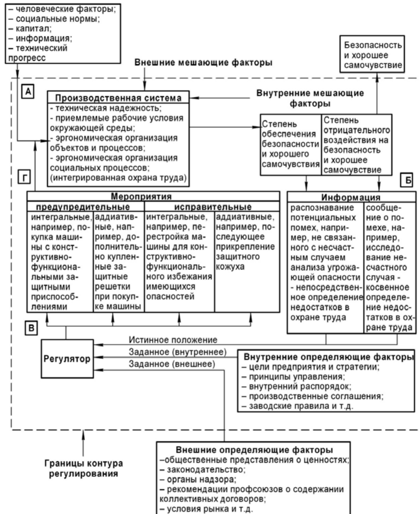
Рис. 2. Схема производственной системы в форме контура регулирования: А – производственная система; Б – величина регулирования; В – регулятор принимаемых решений; Г – мероприятия для устранения факторов помех
