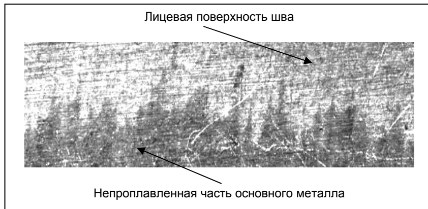
Рис. 4. Продольные макрошлифы корневой части сварных швов алюминиевого сплава Д-16: а – без осцилляции пучка; б – частота осцилляции пучка f = 60 Гц; в – частота осцилляции пучка f = 65 Гц
