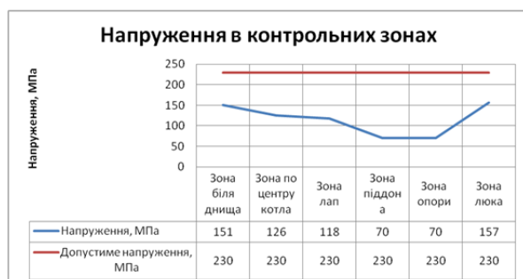
Рис. 12. Графік напружень в контрольних точках під час ударних випробувань
