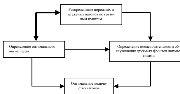
Рис. 2. Структурная схема модели функционирования железнодорожного транспорта предприятия
