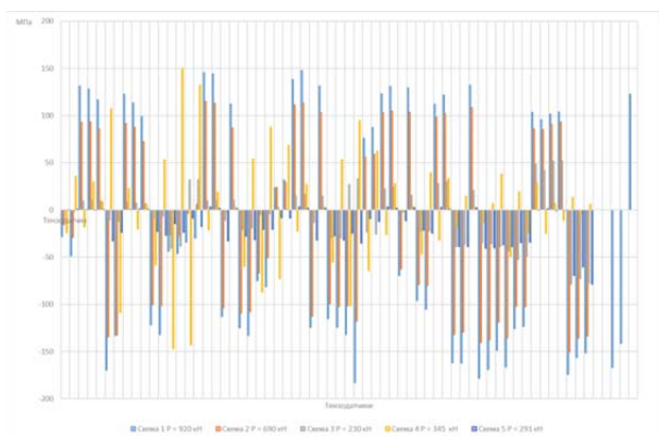
Рис. 2 Осередненні напруження від випробувальних навантажень в елементах конструкції надресорних балок
