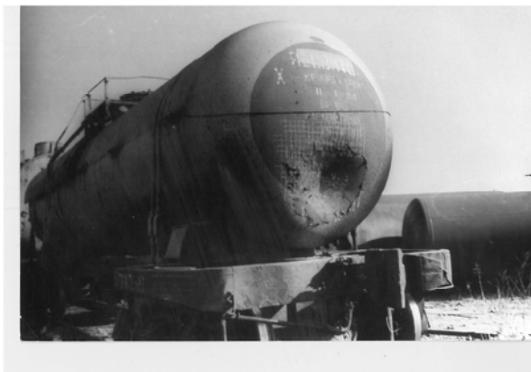
Рис. 3. Пошкодження котла цистерни
