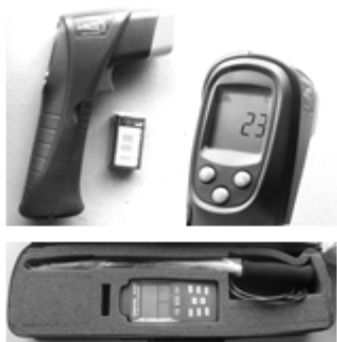
Рис. 4. Вимірювальна апаратура. Пірометр, анемометр
