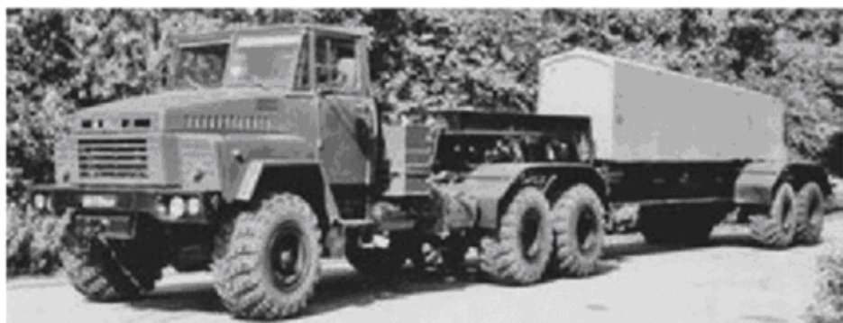
Рис. 1. Активный автопоезд с механическим приводом [3]
