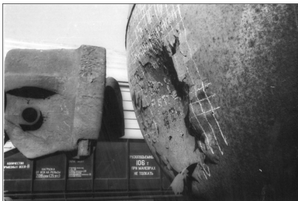
Рис. 9. Дослідний зразок після удару в котел автозчепом
