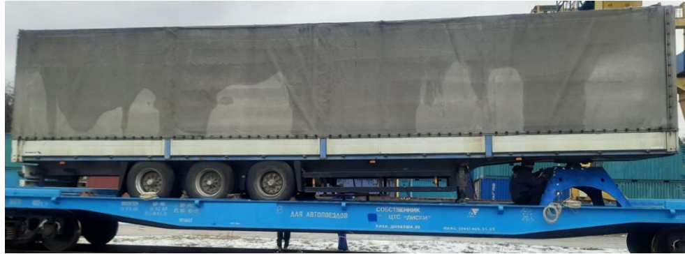
Рисунок 1 - Вагон-платформа моделі 13-9004М з встановленим вантажним напівпричепом
