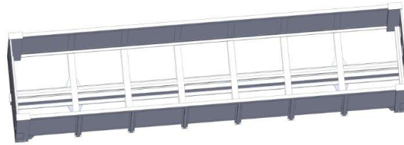
Рисунок 2. Просторова модель кузова напіввагона зі стінами із сендвіч-панелей
