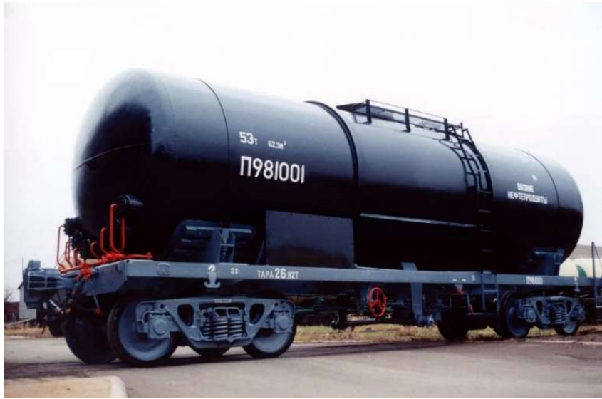
Рисунок 2 – Вагон-цистерна з паровою сорочкою для перевезення в'язких нафтопродуктів
