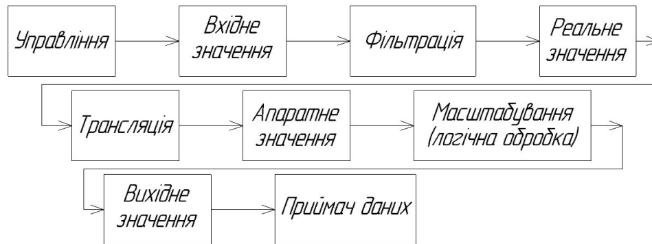
Рис. 2. Структура обробки даних у вихідних каналах
