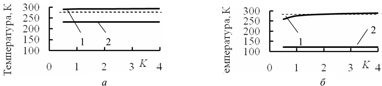
Рис.3. Зависимость конечной температуры адсорбента (1) и газа десорбции (2) от величины константы K при давлении адсорбции 0,5 МПа (а) и 6 МПа (б); ----- температура замерзания воды.
