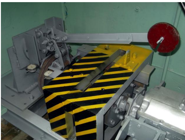
Рис. 4. Важільна система навантаження дискового гальма стенда
