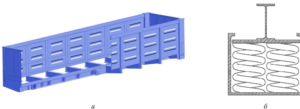
Рисунок 1 – Удосконалена несуча конструкція напіввагона: а – несуча конструкція напіввагона з пружними елементами в хребтовій балці; б – переріз хребтової балки
