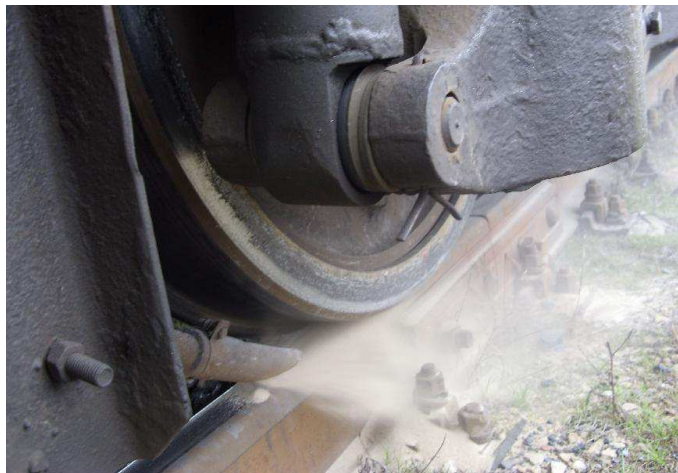
Рисунок 1 - Процесс подачи (в эксплуатации) песковоздушной смеси из наконечника песочной системы локомотива на рельс
