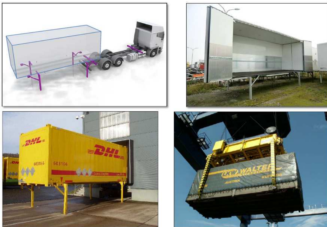
Рисунок 1 – Елементи технології застосування знімних кузовів
