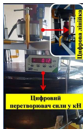
Рис. 3. Контроль вертикальних деформацій цифровою лінійкою та величини сили
