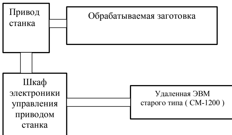
Рис. 1. Укрупненная структурная схема системы управления станка до проведения усовершенствования системы управления станком ЧПУ
