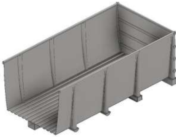
Рисунок 3.62 – Розріз запропонованого мультифункціонального концепту напіввагону посередині
