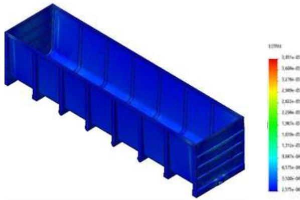
Рисунок 3.67 – Розподіл деформацій для першого розрахункового режиму запропонованого мультифункціонального концепту напіввагону (розтягнення)
