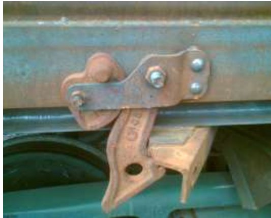
а) фото механізму запирання з заклепковим з'єднанням
