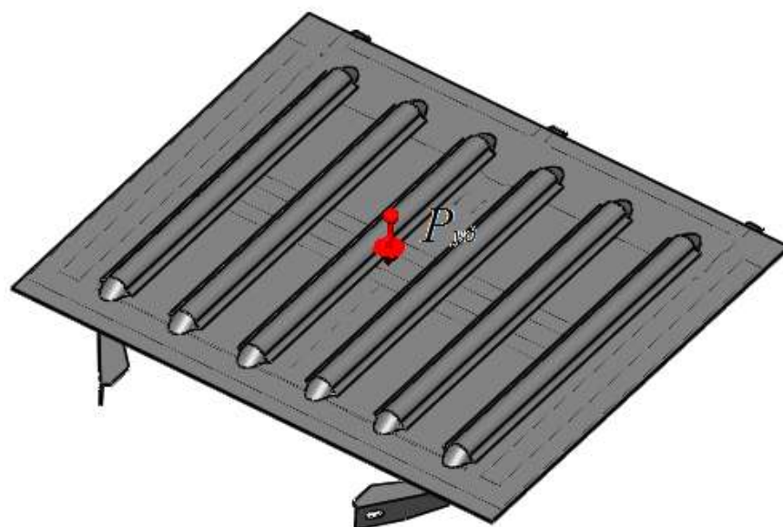
Рисунок 1.18 – Модель міцності кришки люка
