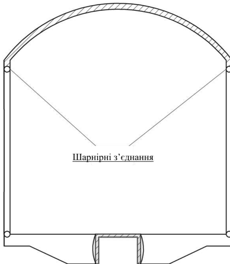
Рисунок 3.26 – Переріз мультифункціонального шарнірного концепту кузова універсального критого вагона
