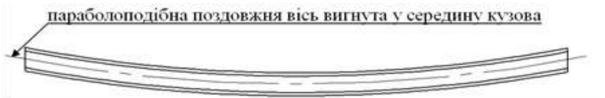
Рисунок 3.6 – Вид зверху на корисно попередньо деформовану стіну бокову концепта окатишевозу
