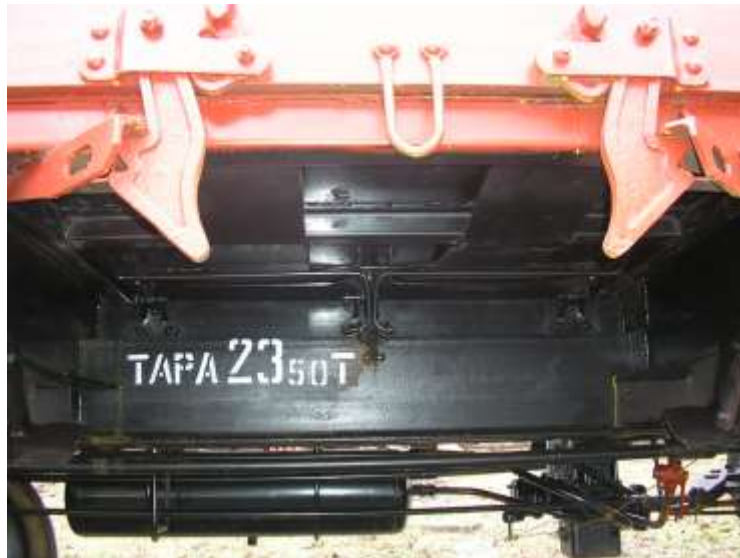
Рисунок 2.19 – Розвантажувальний пристрій напіввагону в закритому стані зі стрингерною кришкою люка
