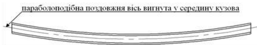
Рисунок 3.3 – Вид зверху на корисно попередньо деформовану стіну бокову концепта критого вагона-хопера для перевезення цементу
