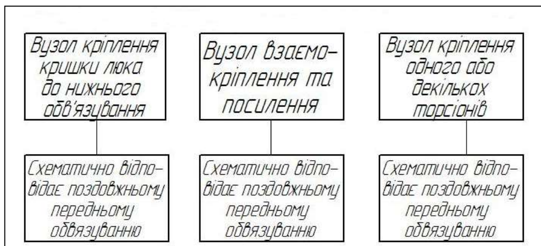
Рисунок 2.13 – «І-АБО» - дерево конструктивного виконання окремих елементів кришки люка
