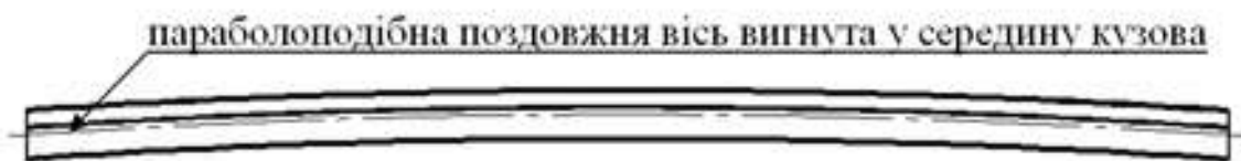
Рисунок 3.2 – Вид збоку на корисно попередньо деформовану балку хребтову концепта критого вагона-хопера для перевезення цементу
