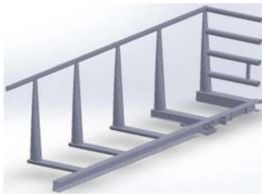
Рисунок 3.60 – Чверть кузова запропонованого мультифункціонального концепту напіввагону
