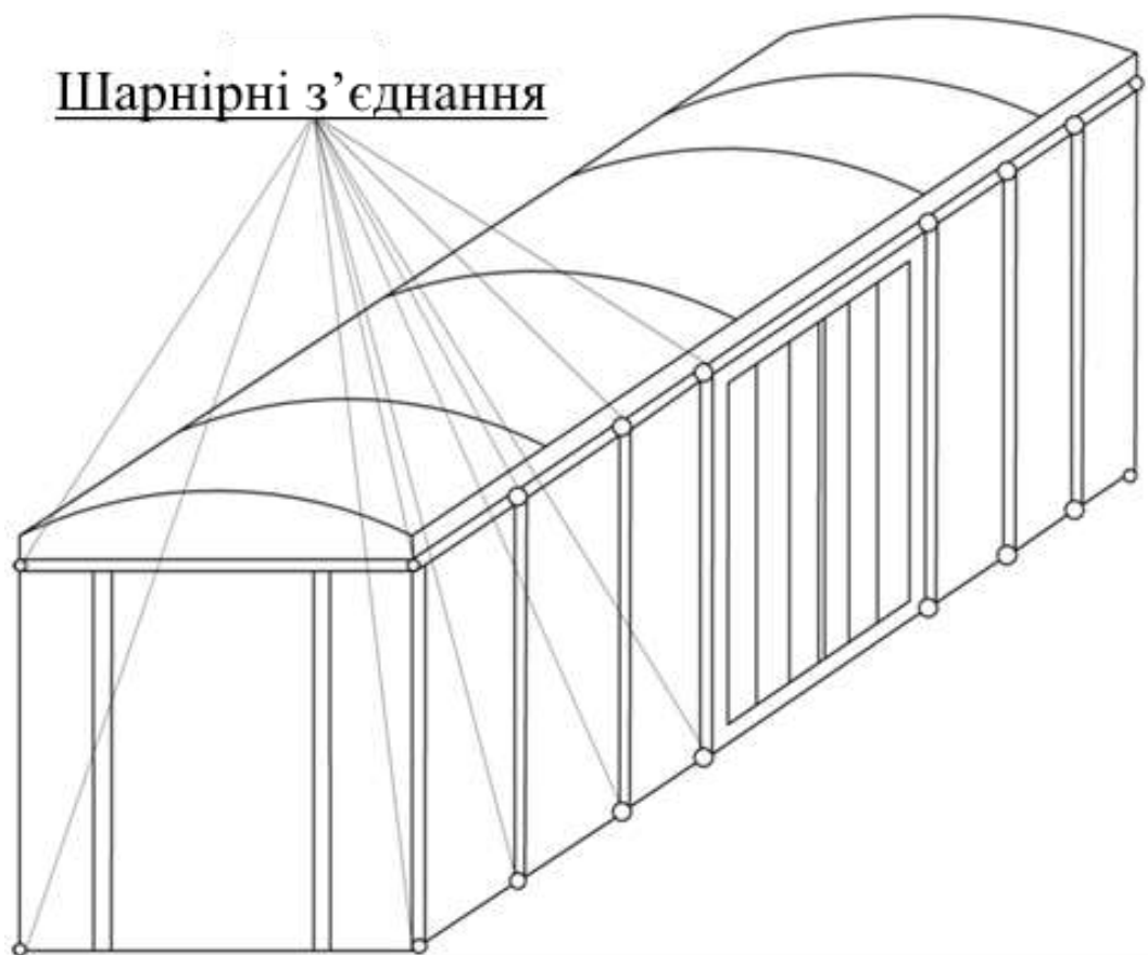
Рисунок 3.25 – Мультифункціональний шарнірний концепт кузова універсального критого вагона
