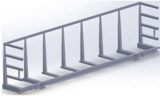
Рисунок 3.59 – Вигляд запропонованого мультифункціонального концепту напіввагону з розрізом посередині
