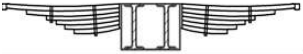
Рисунок 3.9 – Переріз концепту поперечних балок рами з листових ресор
