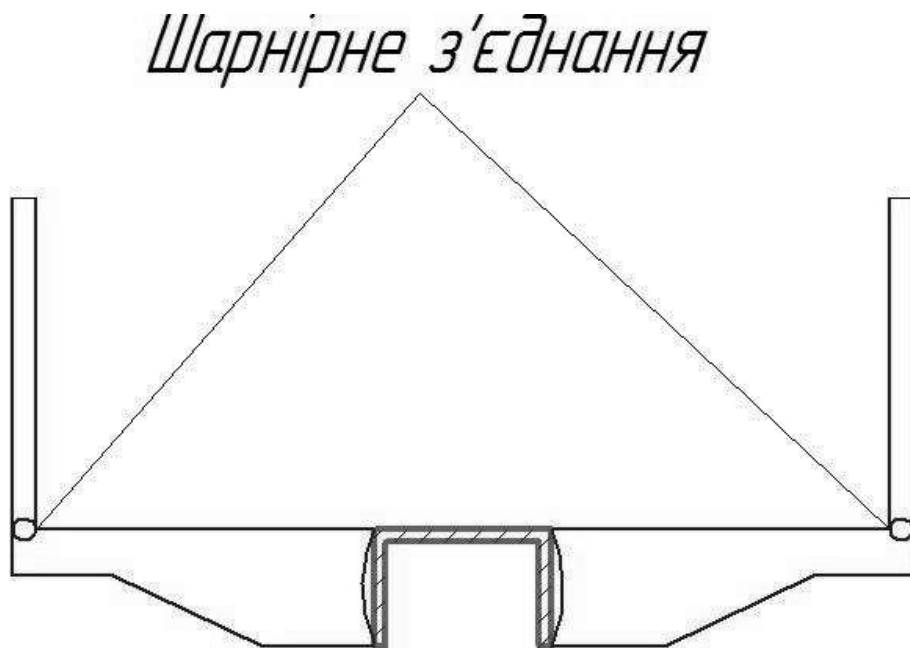
Рисунок 3.28 – Переріз мультифункціонального шарнірного концепту кузова напіввагону глухонного
