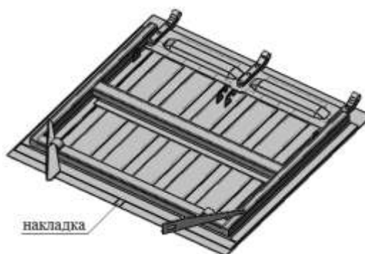
Рисунок 2.30 – Розміщення накладки для моделювання прикладення навантаження до кришки люка від підтягування ломиком
