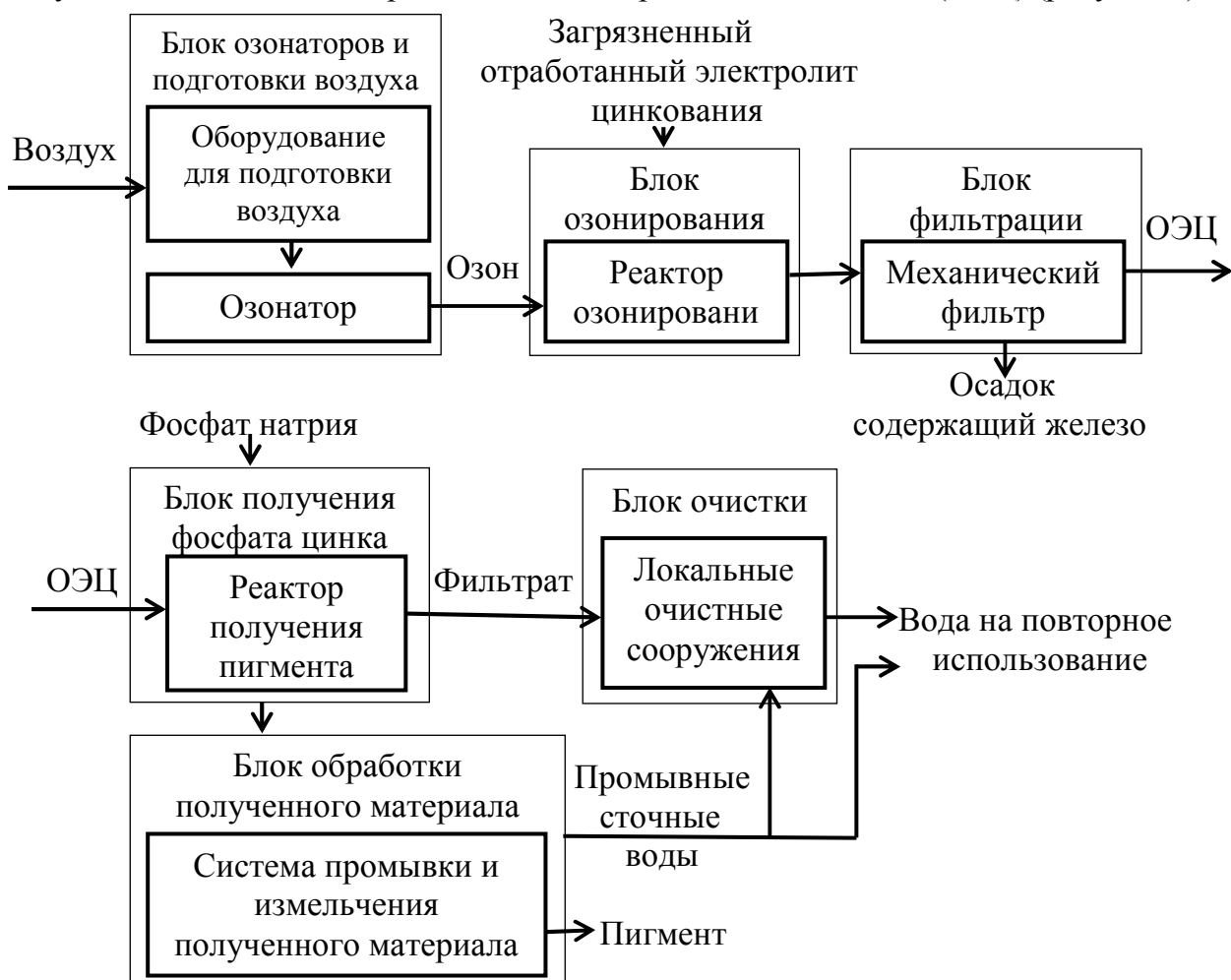
Рисунок 1 – Принципиальная блок-схема получения пигментов из отработанных электролитов цинкования
