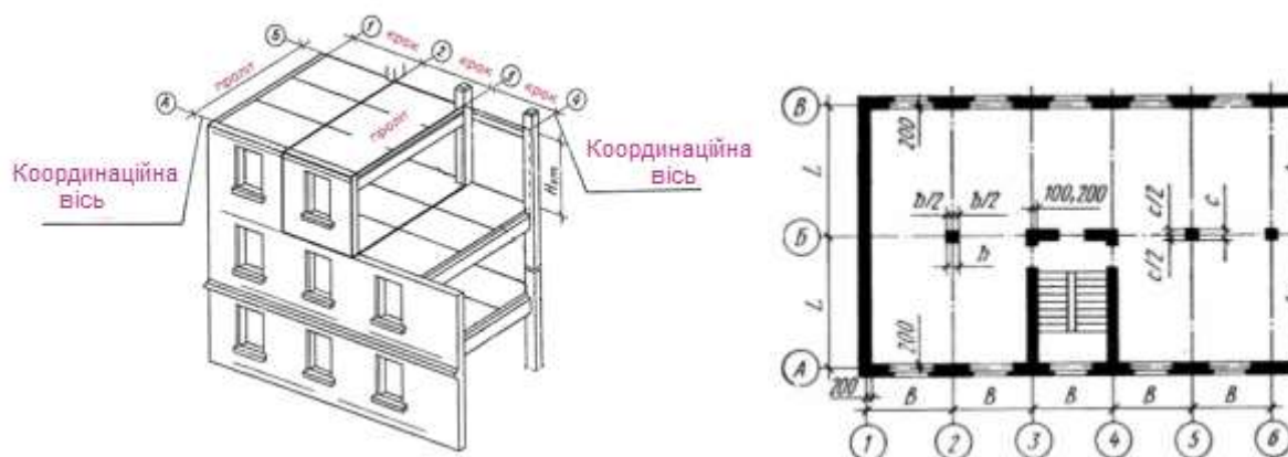
Рис. 2.2. Схема розташування координаційних осей у плані будинку: В – крок; L – прольот
