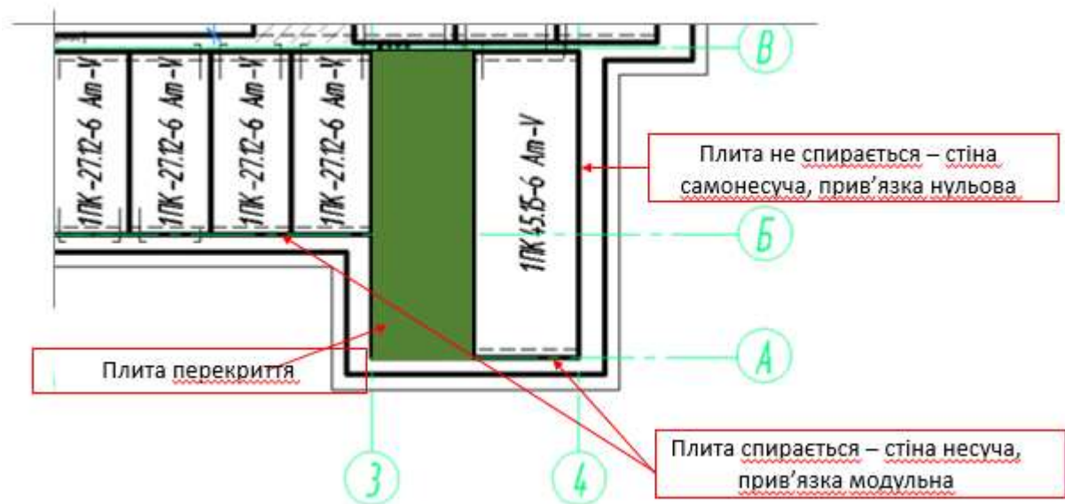
Рис. 2.10. Прив'язка для стін залежно від несучої здатності стін
