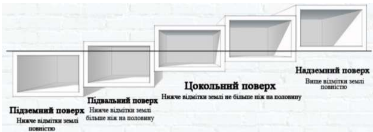
Рис. 3.2. Назви поверхів залежно від розташування рівня підлоги відносно планувальної позначки землі
