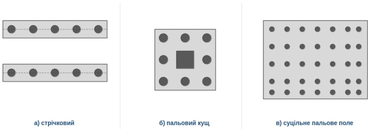
Рис. 6.1. Види пальових фундаментів в залежності від розміщення паль в плані
