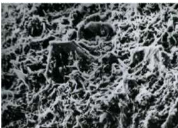
Рис. 8.3.3. Контактна поверхня заповнювача з короткими окремими кристалами еттрінгіту ( \times 2000 ). Зруйнований бетон житлового будинку
