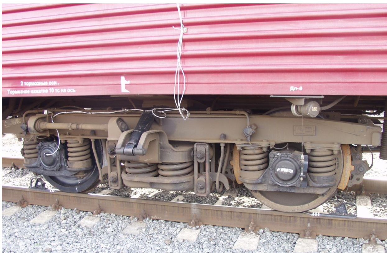
Рисунок 3.64 – Візок типу КВЗ-ЦНИИ-М з дослідною ВКП
