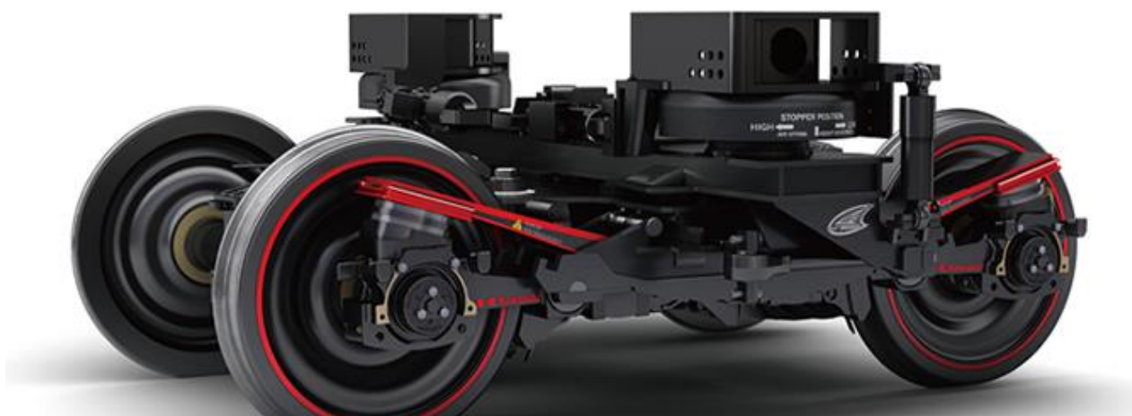
Рисунок 1.31 – Візок марки "EfWING" з пружно-дисипативними несучими елементами
