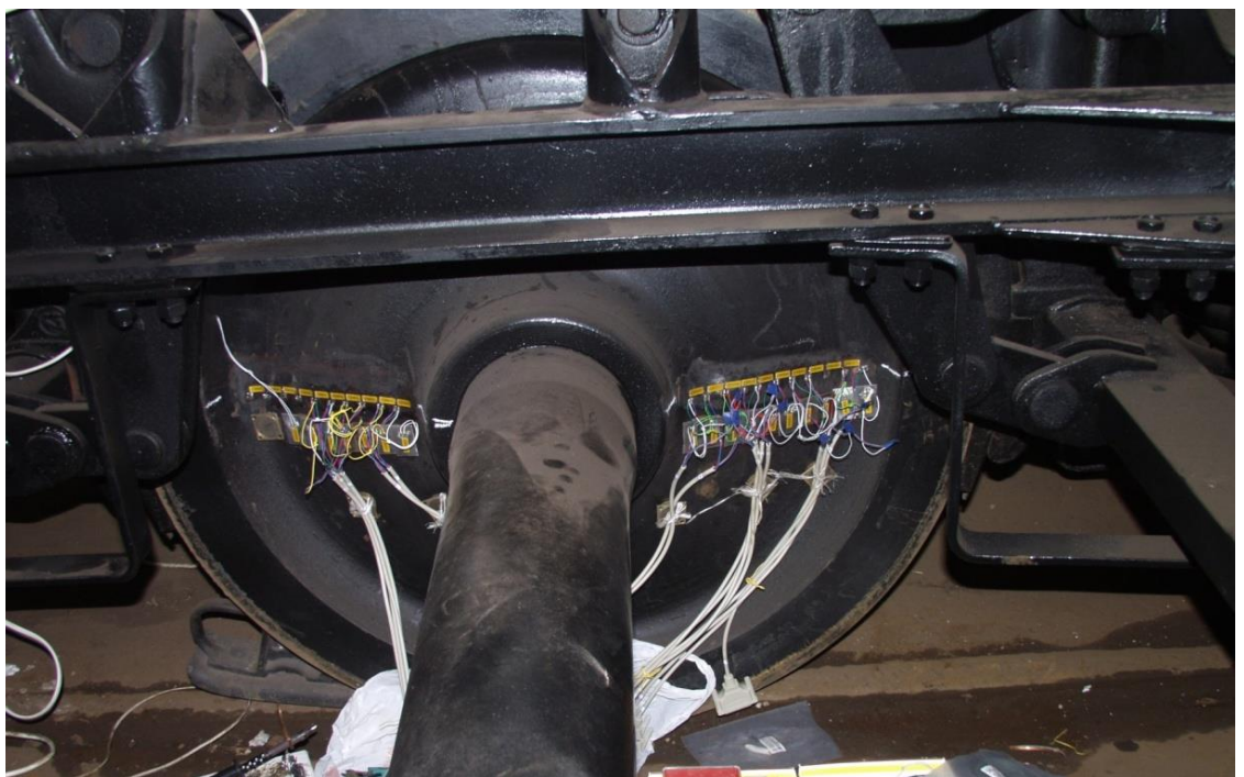
Рисунок 3.32 – Розміщення тензорезисторів на внутрішній поверхні диску колеса
