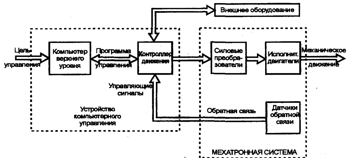
Рис. 5.1 - Структура системы управления функциональными движениями
