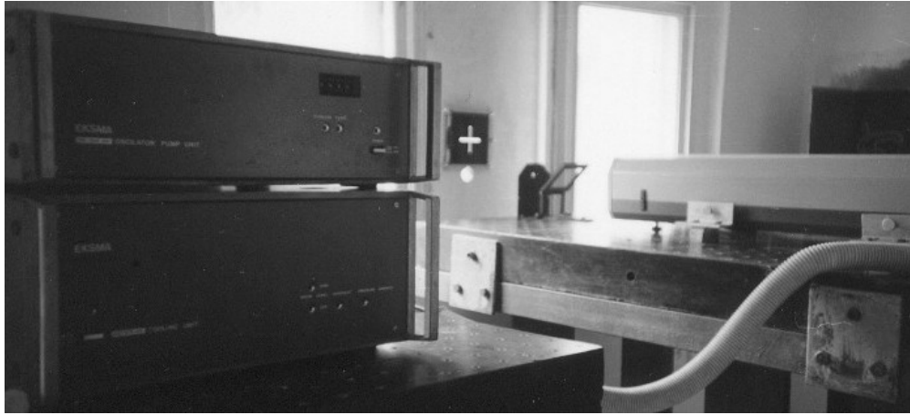
Рис. 3. Передатчик ЛЛС с пикосекундным лазером, генерирующим импульсы излучения на длине волны 0,53 мкм после удвоения частоты
