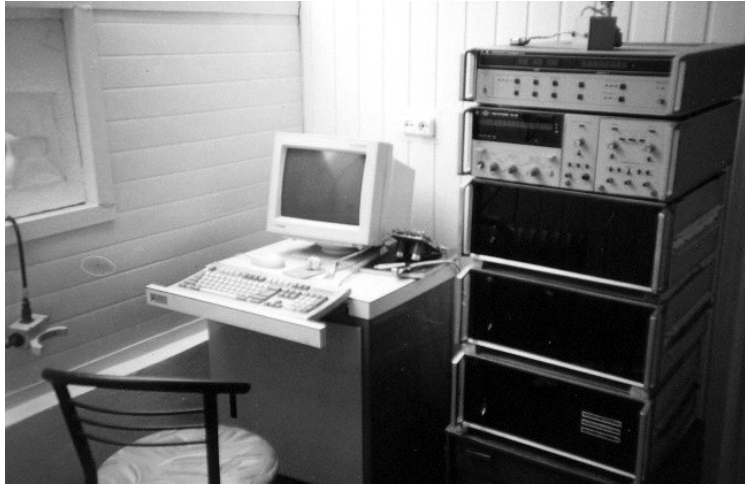
Рис. 2. Телескоп ТПЛ-1М. Рабочее место оператора, устройства компьютерного управления телескопом, а также аппаратура для обработки и регистрации информации
