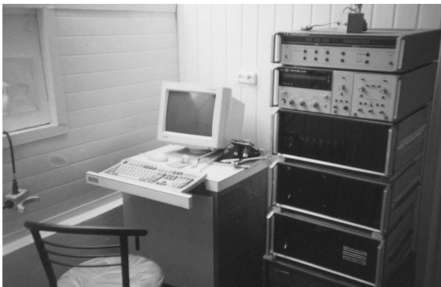
Рис. 2. Рабочее место оператора; справа в стойке находятся компьютерные устройства управления телескопом и измеритель координат ИСЗ с компьютерной регистрацией
