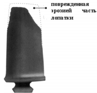
Рис. 3. Лопатка компрессора вертолетного двигателя с эрозионными повреждениями
