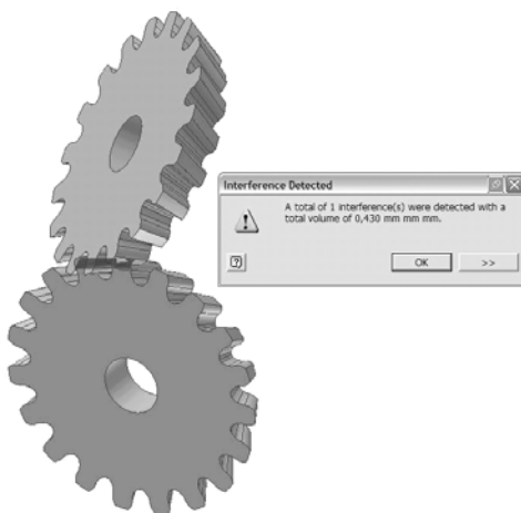
Рис.7. Интерференция сопряженных гипоидных зубчатых колес
