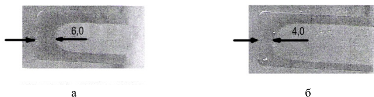
Рис. 2. Расположение закаленного слоя на расстоянии 10 мм от вершины зуба:
