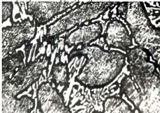
Рис. 2. Микроструктура опытного сплава после выдержки при 650 0 С (x800)
