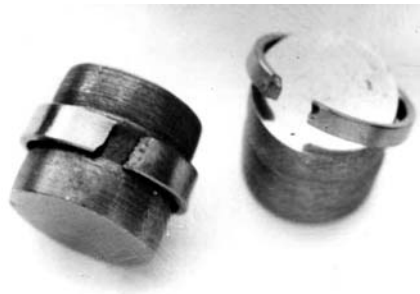
Рис. 4. Вид кольцевых образцов, доведенных до разрушения раздочей на деформируемых оправках
