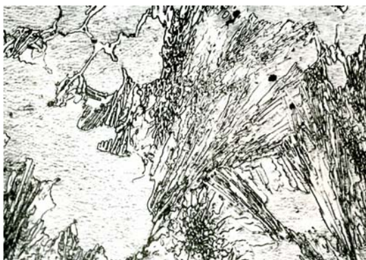
Рис. 1. Микроструктура опытного сплава в литом состоянии
