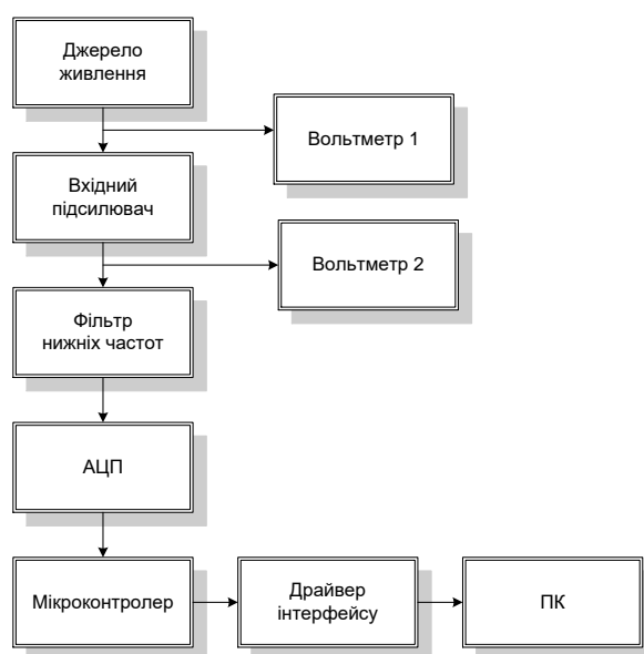
Рисунок 1 – Структурна схема визначення впливу частоти зрізу ФНЧ на вході АЦП на основну похибку компонентів каналу обробки аналогових сигналів ІВС
