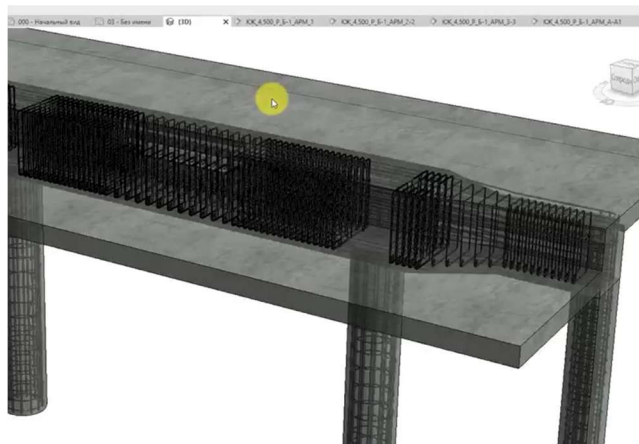
Рис. 5. Результати армування балки складного перетину в Revit
