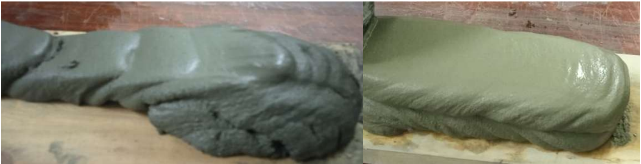
Рис. Екструзія суміші для випробування: а – не задовільна, б – задовільна
