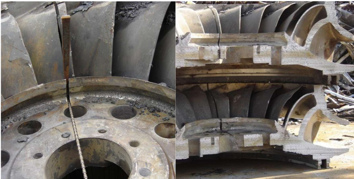
Рис. 1. Різання металу алмазним канатом. Сухе різання. Турбіна Пелтона (ковшова). Матеріал – CrSt
