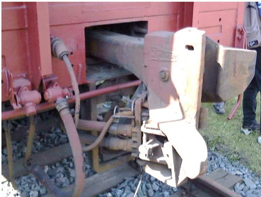
Рис. 6.6. Загальний вигляд автозчепу Intermat Fig. 6.6. General view of the Intermat automatic coupler
