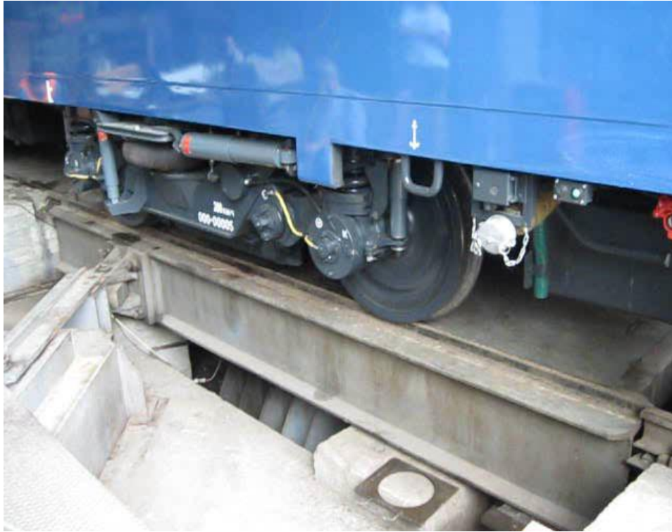
Рис. 3.1. Приклад стендового обладнання для визначення моменту опору повороту візка відносно кузова (Лабораторна база Інституту залізничного транспорту, м. Варшава) Fig. 3.1. Example of bench equipment for determining the moment of resistance to turning of a bogie relative to the body (Laboratory base of the Institute of Railway Transport, Warsaw)
