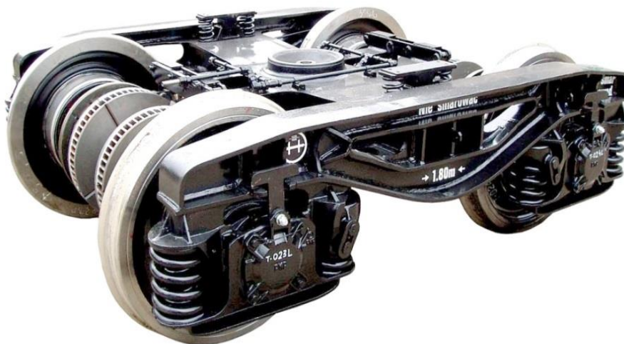
Рис. 1.18. Візок типу 7RS з ПКП SUW2000 Fig. 1.18. 7RS type bogie with GCW SUW2000
