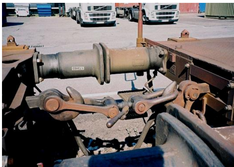
Рис. 6.1. Зчеплення суміжних вагонів гвинтовою стяжкою Fig. 6.1. Coupling adjacent wagons with a screw coupler
