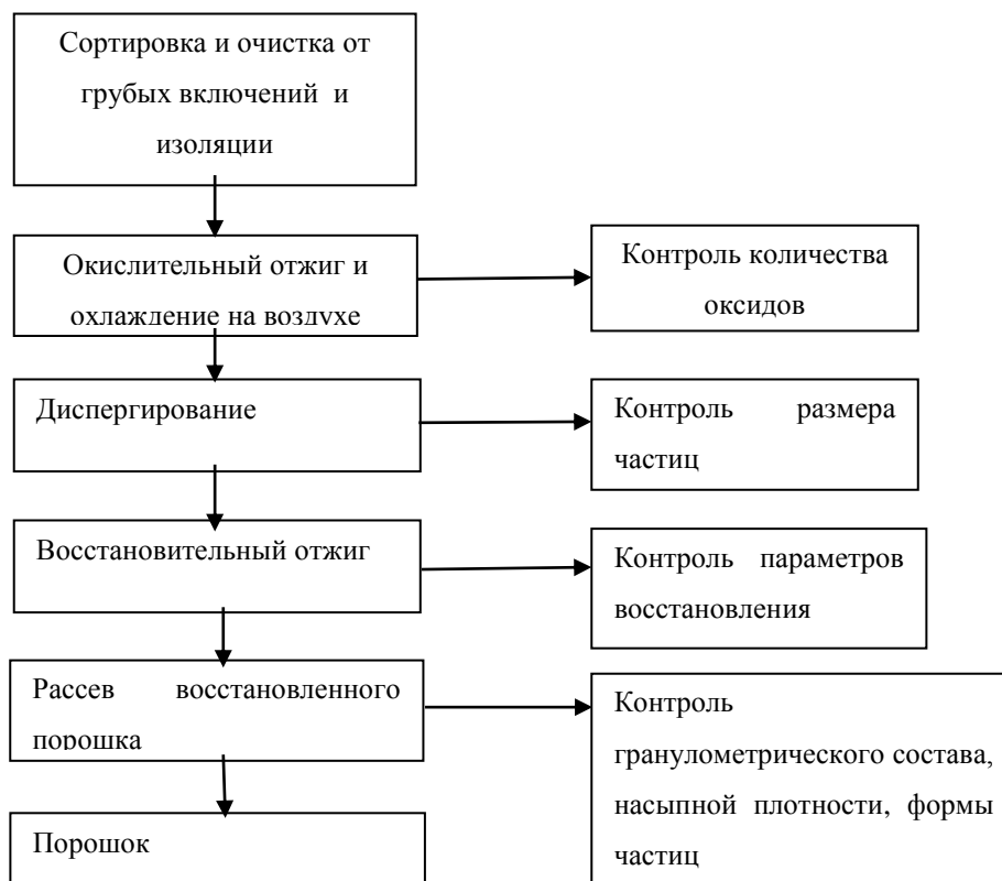
Рис. 1. Схема технологического процесса получения порошка меди из отходов
