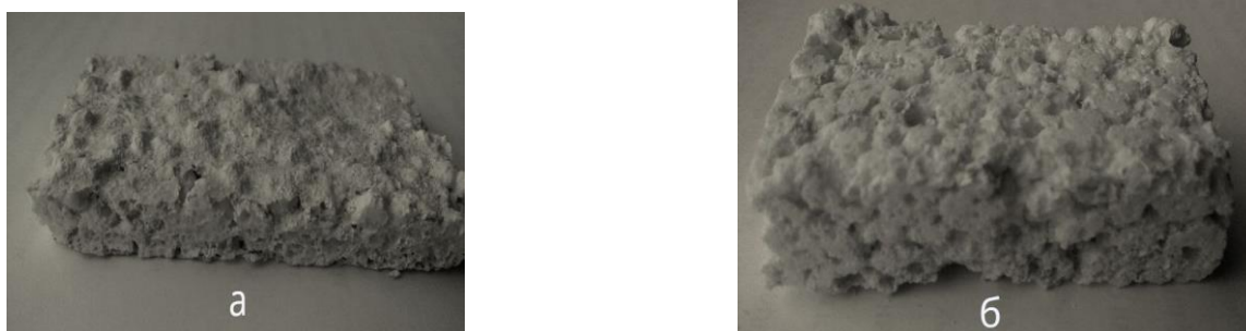
Рис.1 а) пеноблок, изготовленный сушильном шкафу; б) пеноблок, изготовленный в СВЧ-установке.
