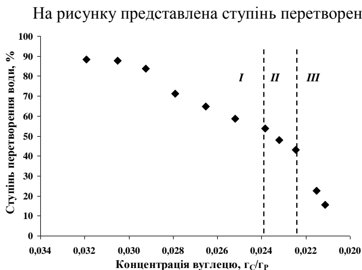
Рис. Ступінь перетворення води в синтез-газ від концентрації вуглецю в розплаві
