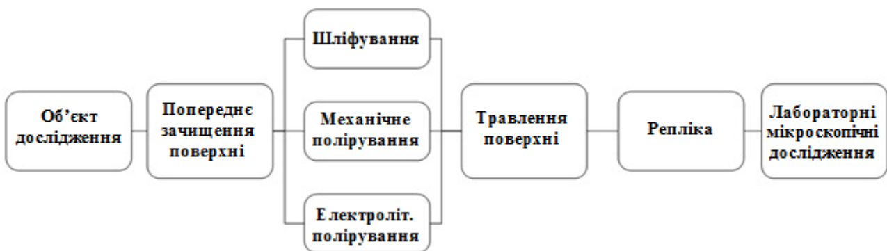
Рис. 3.5. Схема реалізації методики проведення металографічних досліджень методом реплік
