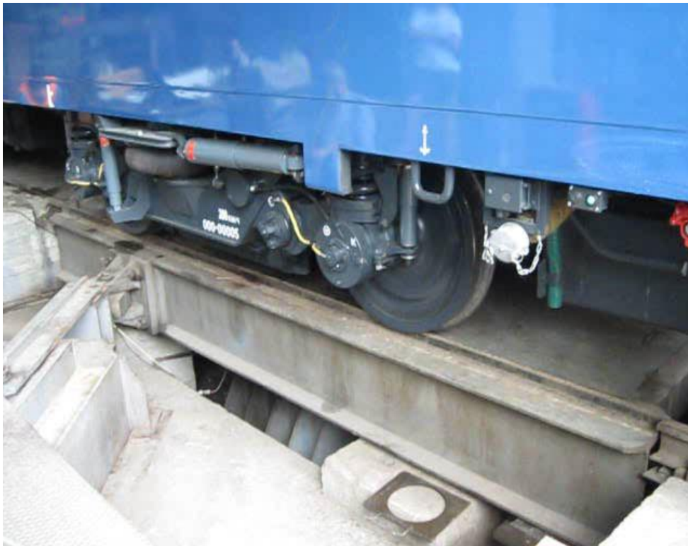
Рис. 5.1. Приклад стендового обладнання для визначення моменту опору повороту візка відносно кузова (Лабораторна база Інституту залізничного транспорту, м. Варшава)
