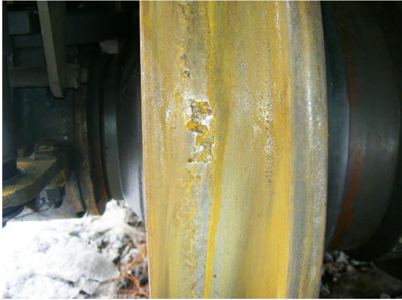
Рис. 7.6 Вищербина на поверхні кочення колеса розсувної колісної пари
