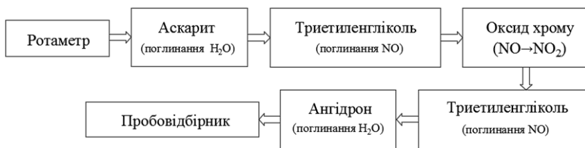
Рис. 4.5. Схема підготовки та відбору проб
