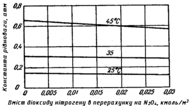
Рис. 1.16. Залежність константи рівноваги реакції полімеризації NO_2 від його концентрації при різних температурах
