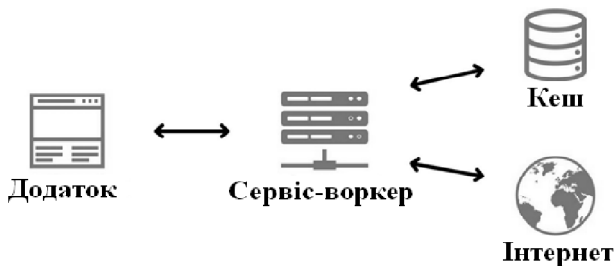
Рис. 1. Схема взаємодії між компонентами PWA
