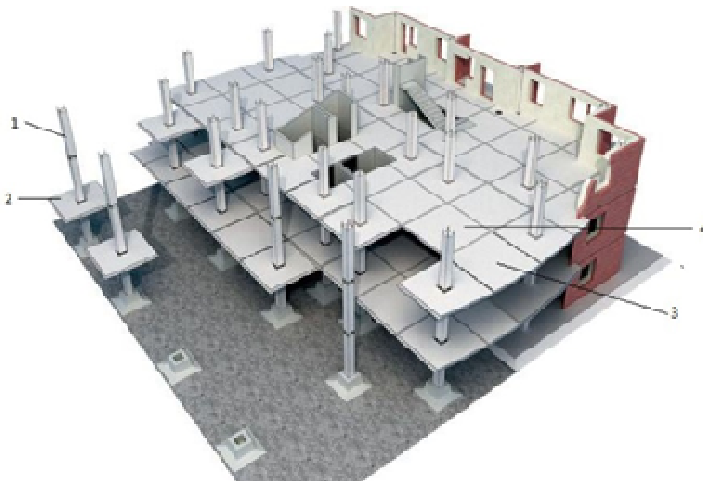
Рис. 1. Безконсольно-безкапітельно-безбалкова конструктивна система будівель: 1 – колона; 2 – надколонна плита; 3 – міжколонна плита; 4 – середня плита
