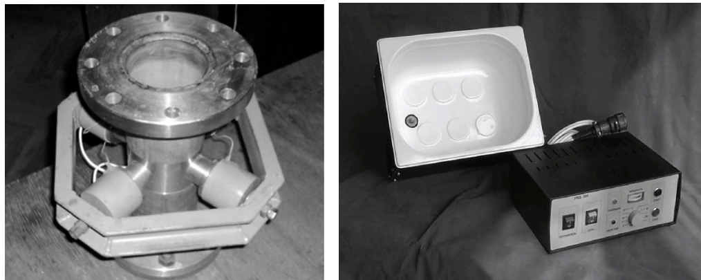
Рис.8. Проточная и непроточная ультразвуковые кавитационные камеры
