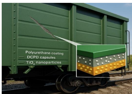
Рисунок 2 – Напіввагон, покритий поліуретановою фарбою з капсулами DCPD та наночастинками TiO_2
