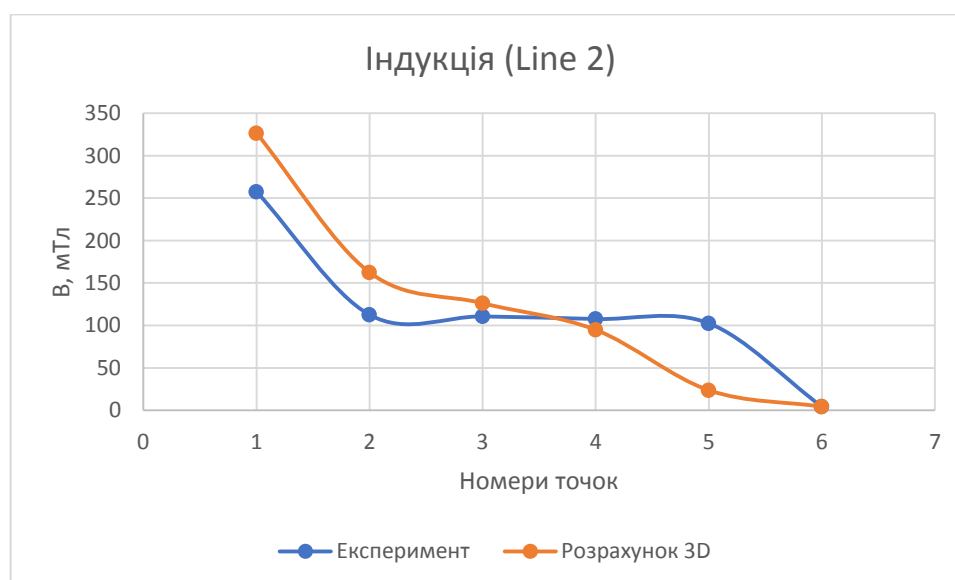
Рисунок 4.6 – Розподіл магнітної індукції вздовж ліній: а – Line 1; б – Line 2
